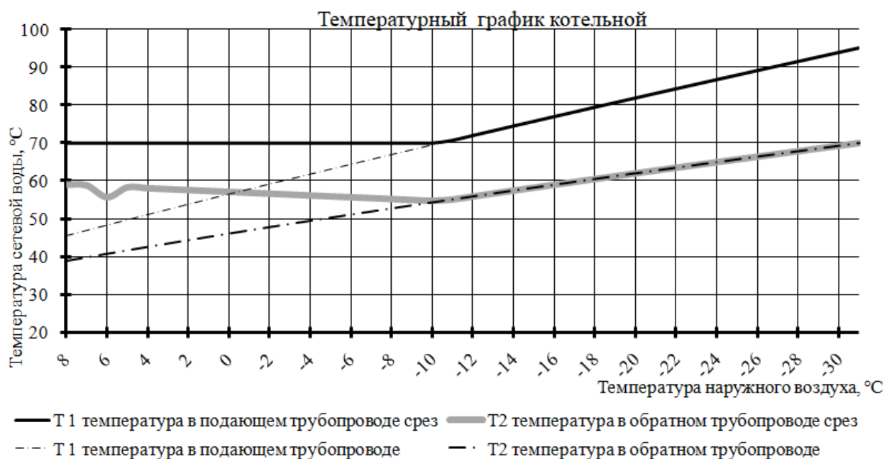
Рисунок 1. Вычисленный фактический график отпуска тепловой энергии котельной
